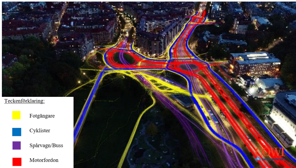
Figur 7. Rörelsemönster för olika trafikanter och trafikslag analyserade med hjälp av DataFromSky. Tidpunkt: tisdag 12 oktober 2021, kl. 7.00-9.00.
