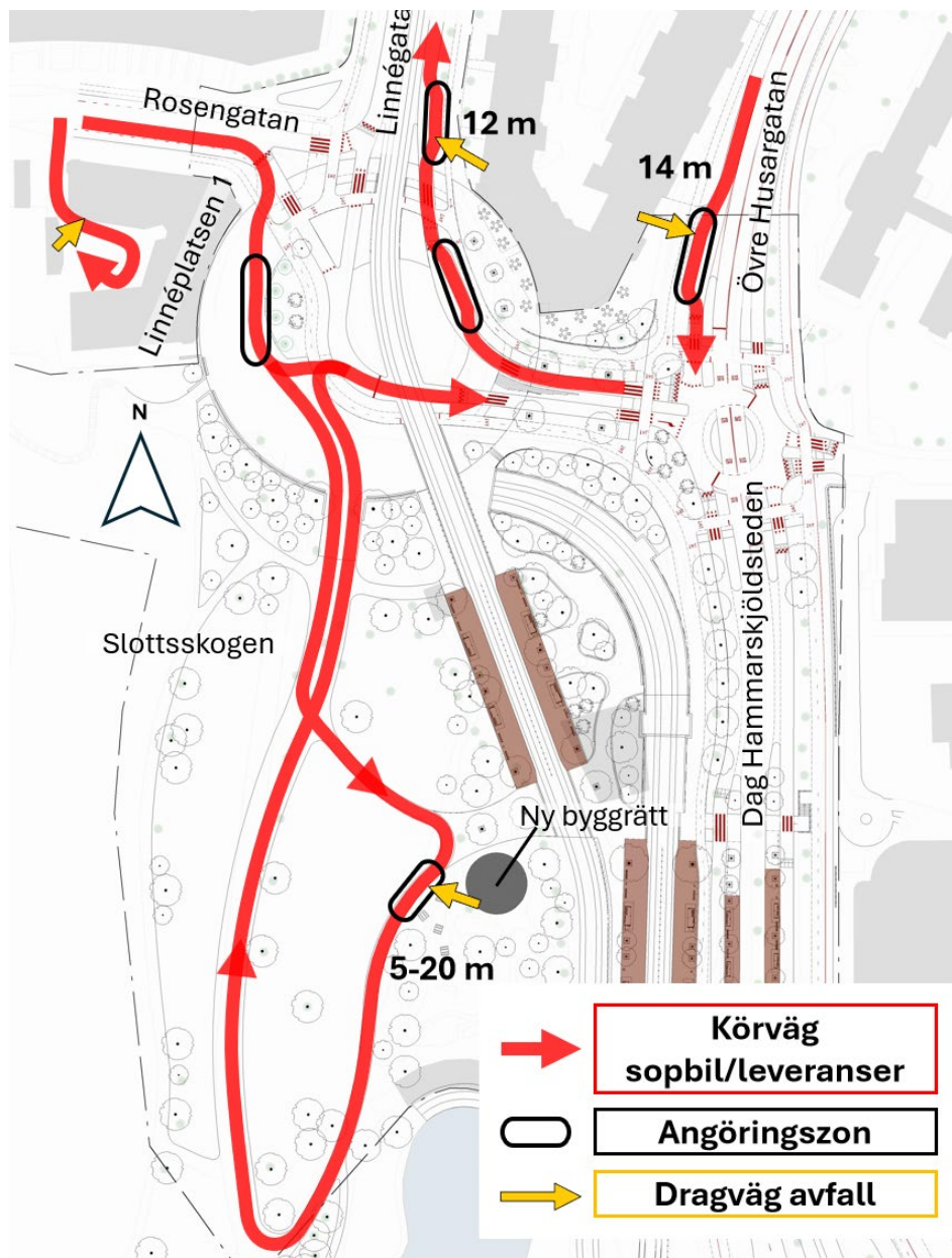
Figur 48. Illustration av körvägar för sopbil och verksamheters leveranser. Orangea pilar visar dragväg mellan sopbil och dörr till miljörum i husfasad. Svarta elipser illustrerar angöringszoner. Linnéplatsen 1 hanterar sin sophämtning via gården väster om byggnaden.
